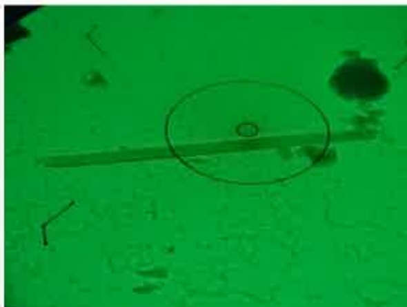
Photo 1 : Fibre d'actinote , vue en META (Grand cercle 3.70 μm, petit cercle 0.46 μm)
