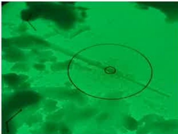
Photo 3 : Fibre de trémolite , vue en META (Grand cercle 2.96 μm, petit cercle 0.37 μm)
