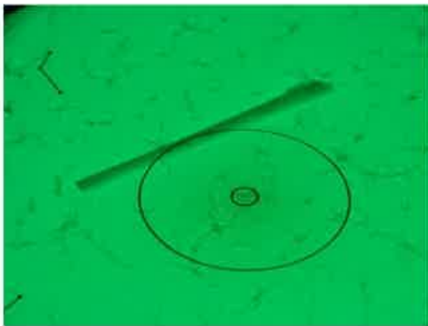
Photo 1 : Fibre minérale , vue en META (Grand cercle 2.96µm, petit cercle 0.37µm)
