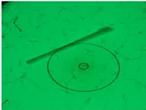
Photo 20 : Fibre d'actinote , vue en META (Grand cercle 2.96µm, petit cercle 0.37µm)
