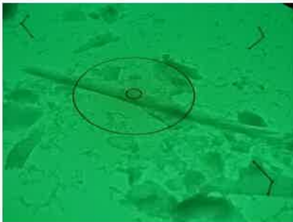
Photo 2 : Fibre minérale , vue en META (Grand cercle 2.96µm, petit cercle 0.37µm)
