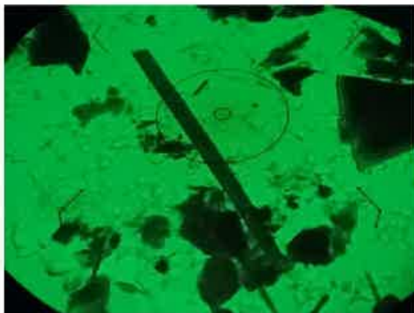
Photo 8 : Fibre d'actinote , vue en META (Grand cercle 2.96µm, petit cercle 0.37µm)
