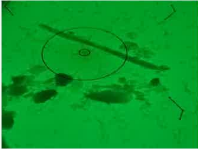
Photo 10 : Fibre minérale , vue en META (Grand cercle 2.96μm, petit cercle 0.37μm)
