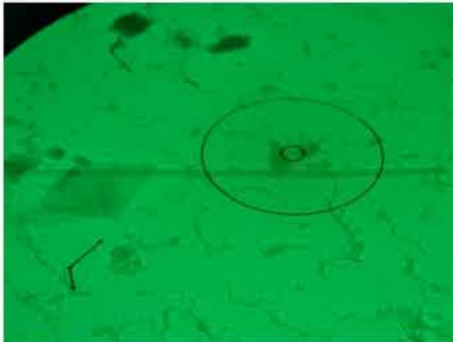
Photo 5 : Fibre minérale , vue en META (Grand cercle 2.96µm, petit cercle 0.37µm)
