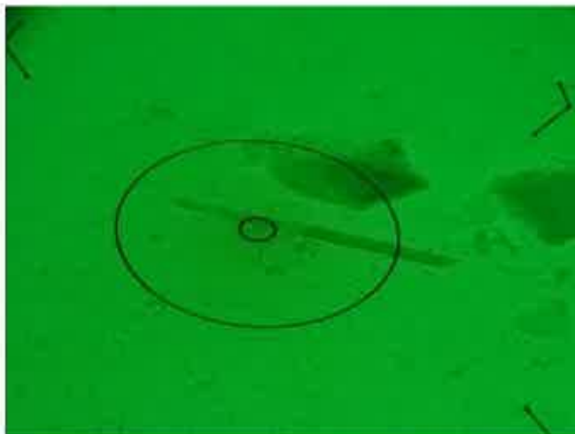
Photo 9 : Fibre minérale , vue en META (Grand cercle 2.96µm, petit cercle 0.37µm)
