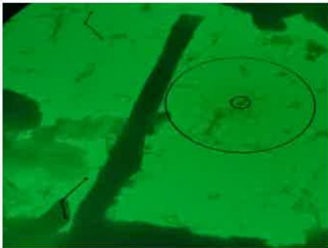
Photo 3 : Fibre minérale , vue en META (Grand cercle 2.96µm, petit cercle 0.37µm)
