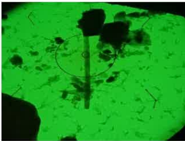
Photo 16 : Fibre d'actinote , vue en META (Grand cercle 2.96µm, petit cercle 0.37µm)
