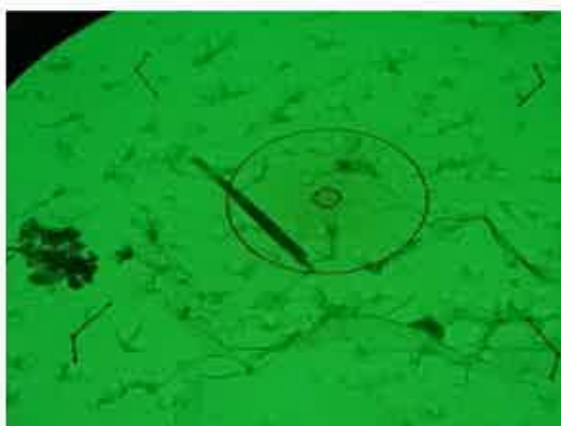
Photo 5 : Particule allongée de chimie proche de la trémolite et d'actinote, vue en META (Grand cercle 2.96µm, petit cercle 0.37µm)
