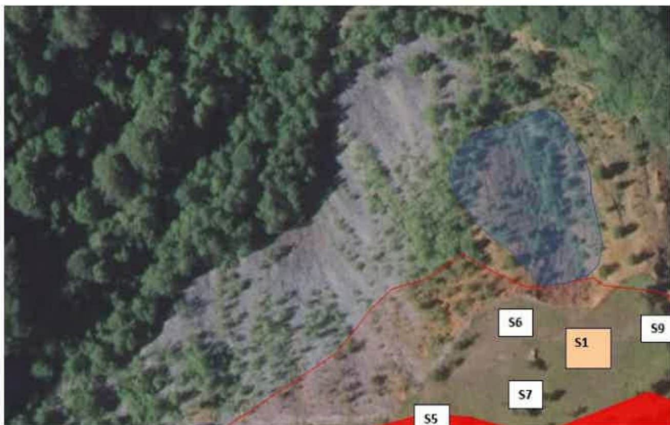
Figure 14 : Implantation, au niveau du carreau de la mine, des sondages de profondeur moyenne, rectangle en blanc.
