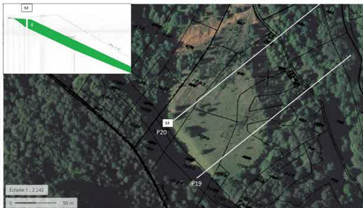
Figure 3: Coupe schématique de la géométrie du dépôt. Positions du forage S3 (verse du Plat des Pommiers). Extrait du rapport ADLAB joint en Annexe 1.
