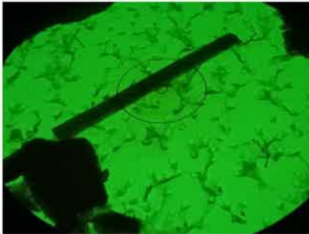
Photo 18 : Fibre d'actinote , vue en META (Grand cercle 2.96µm, petit cercle 0.37µm)
