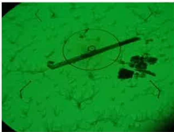
Photo 5 : Particule allongée de chimie proche de la trémolite et d'actinote, vue en META (Grand cercle 2.96µm, petit cercle 0.37µm)
