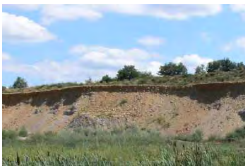
Front de taille dont la pente n'est pas trop forte (source : ANA)
