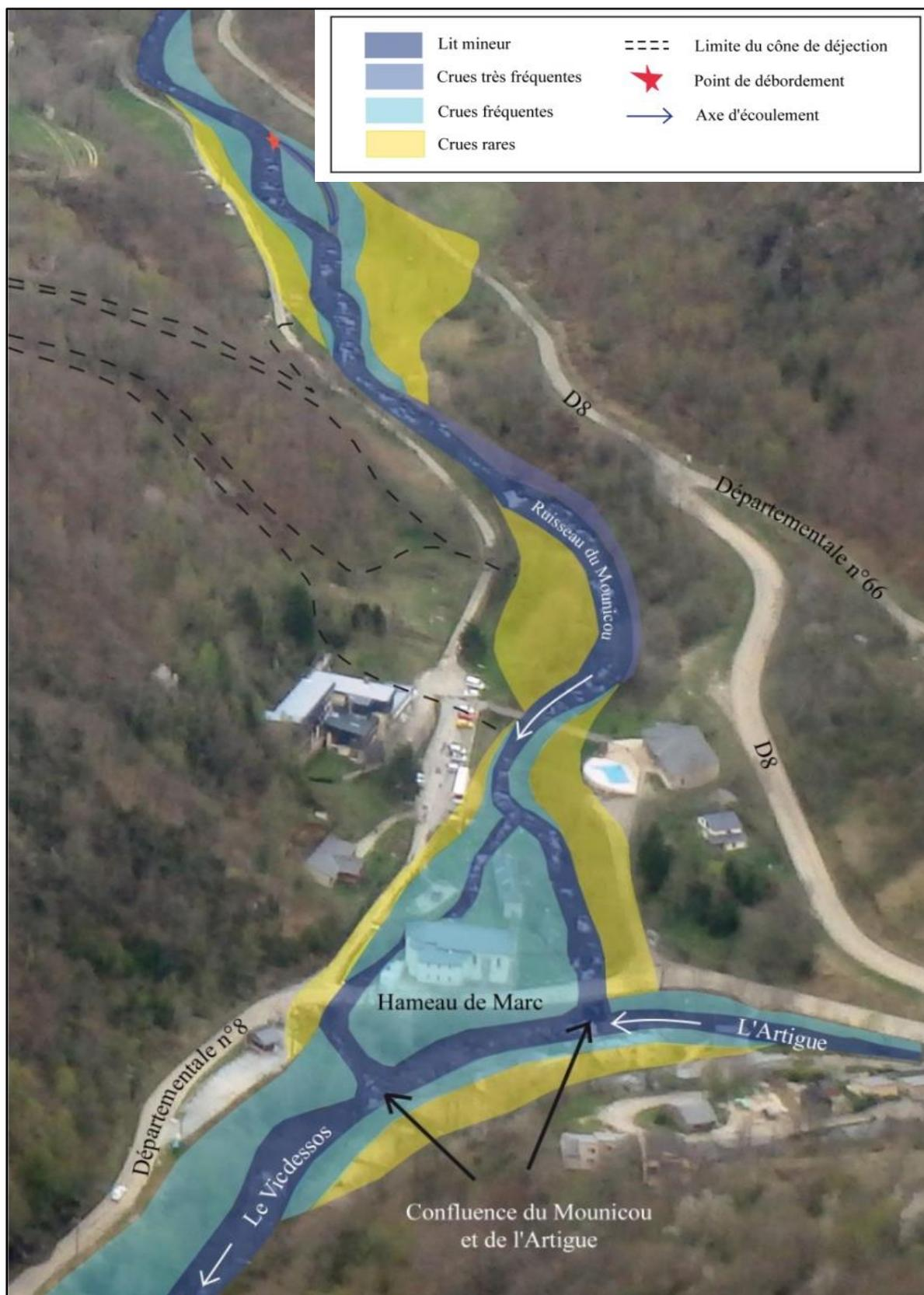
Figure 11 : Illustration du phénomène de crue torrentielle - Le village de Marc (source AGERIN<sub>SAS</sub>)
