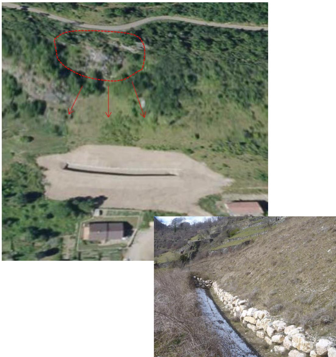
**Figure 20 : Zone de départ et piège à blocs au lieu-dit Vexanne de Darré (Image IGN, AGERINsas)**
