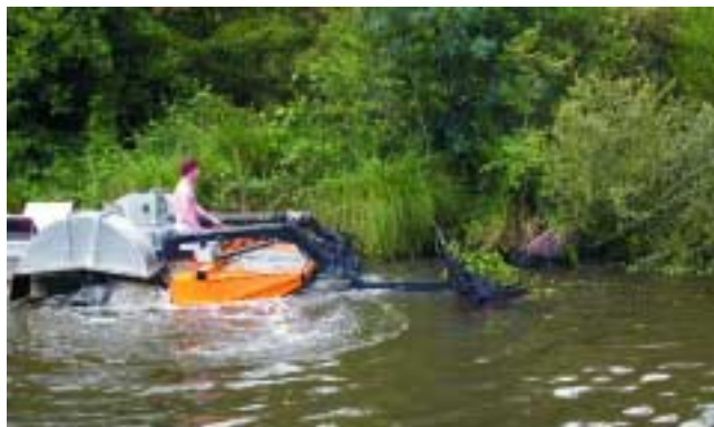
Arrachage de petits herbiers jussies épars, avec un engin flottant équipé de griffes, lors d'une reprise d'entretien saisonnier sur l'Erdre.
