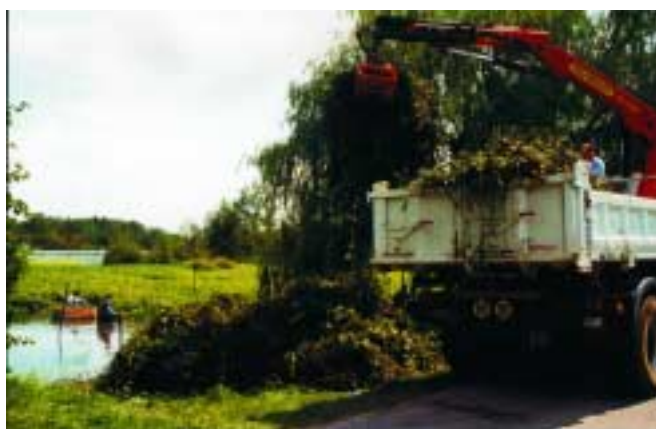
Chargement mécanique des résidus d'arrachage à bord d'un camion. Cette opération terminée, il convient de bâcher ou déployer un filet sur le chargement et d'inspecter les alentours pour récupérer les fragments dispersés.
