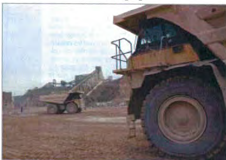
Les camions transportent 100 tonnes de granulats par voyage.
