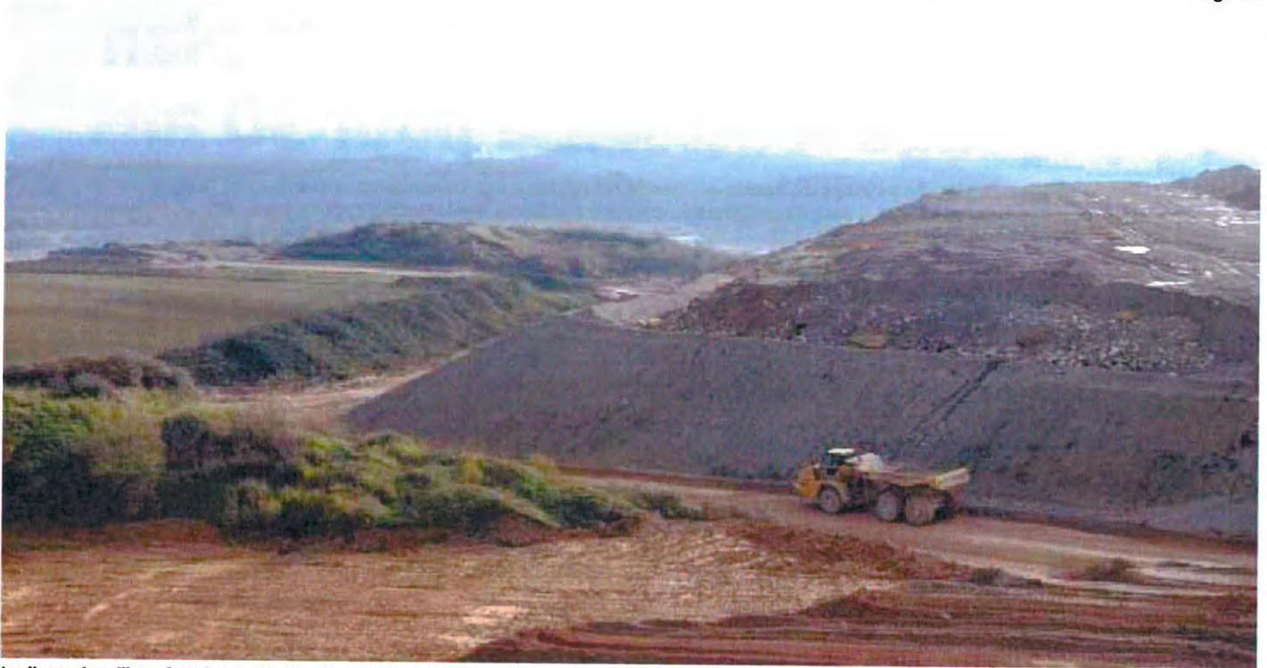
Les lignes de collines, formées de stériles, prennent forme petit à petit, sculptées par les engins de chantier des carrières en exploitation. PHOTO GUY DROLLET
